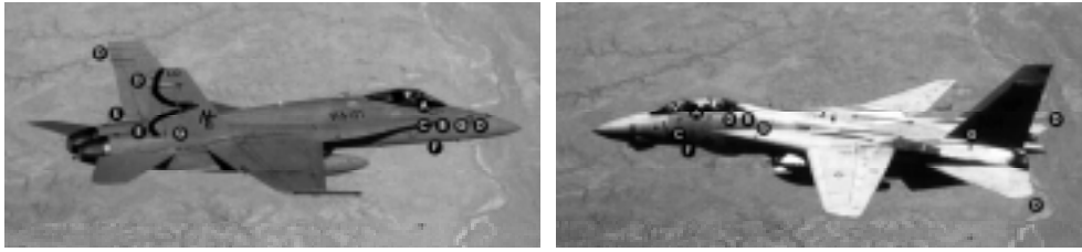
Рис. 3. Размещение элементов приемника AN/ALR-67(V)3/4 на самолетах F/A-18 и F-14: А – панель управления; В – ЭВМ противодействия; С – приемник; D – интегрированный антенный детектор; Е – антенный контроллер; F – интегрированная антенна нижнего диапазона; G – квадратный приемник
